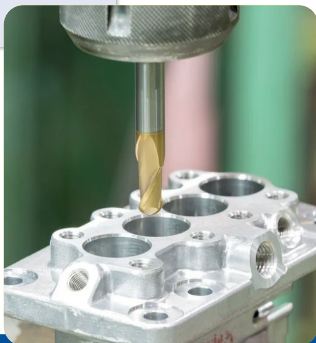
Perçage de centrage sur alliages légers au silicium, série 4000 (aluminiums de fonderie).
